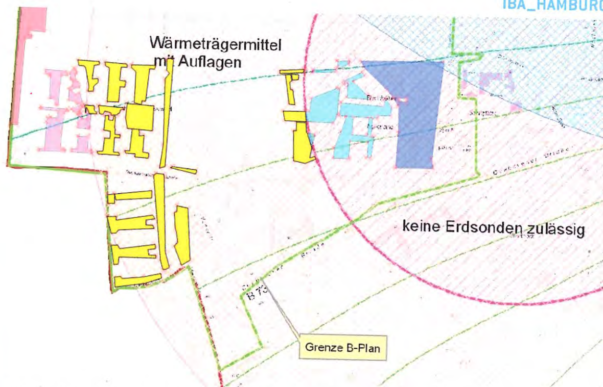
Abbildung 4: Unter Nutzung von Wärmeträgermitteln mit Auflagen für Erdsonden nutzbare Flächen
