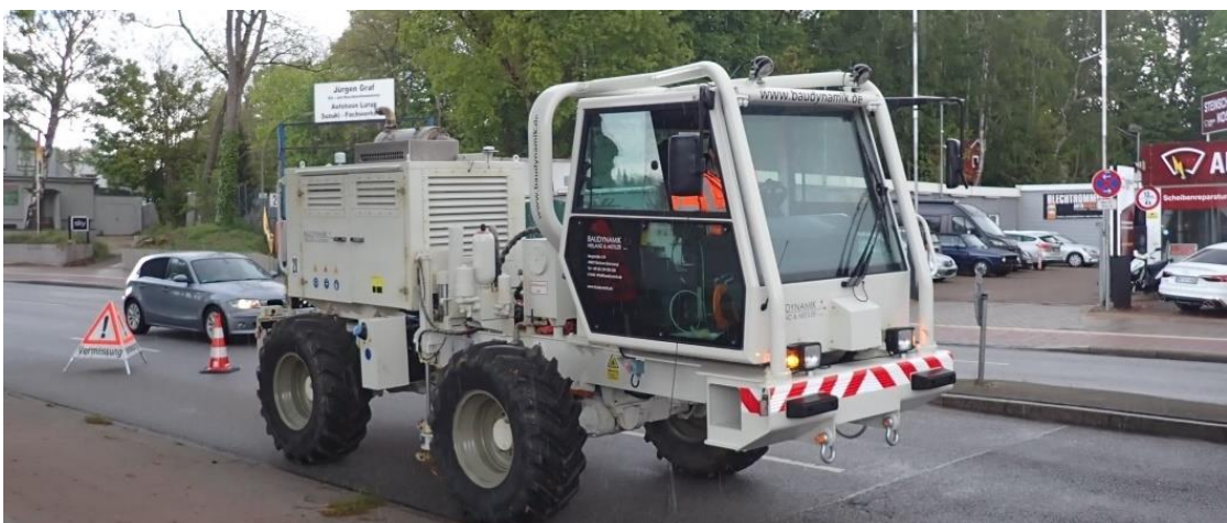
Abbildung 2-2: VibroTruck im Einsatz an der Luruper Chaussee
