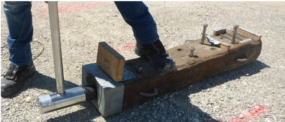
Abbildung 11-2: Großer Impulshammer mit Shearbeam im Einsatz
