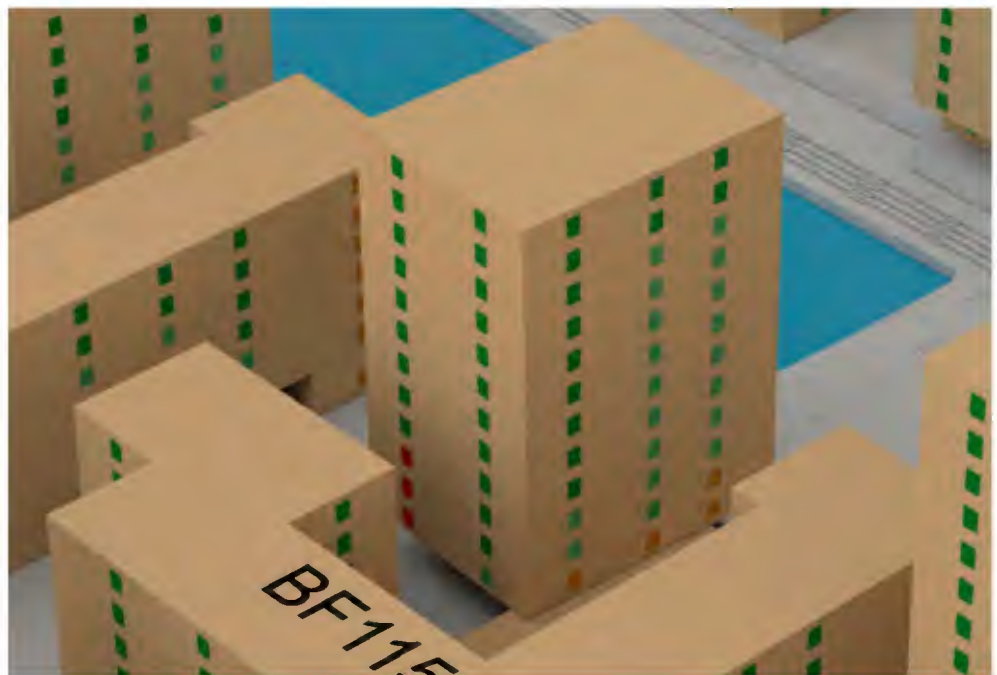
Abb. 35: Baufeld 115 - Südfassade, abstrahiertes Modell - Fensterlaibungsinnenwert am 20.03
