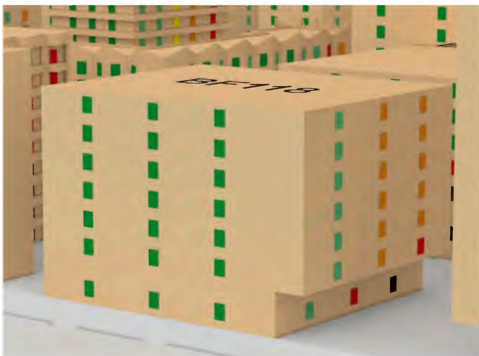
Abb. 89: Baufeld 118 - Ostfassade und Südfassade - Fensterlaibungsinnenwert am 20.03. - Stand: 02.09.2021
