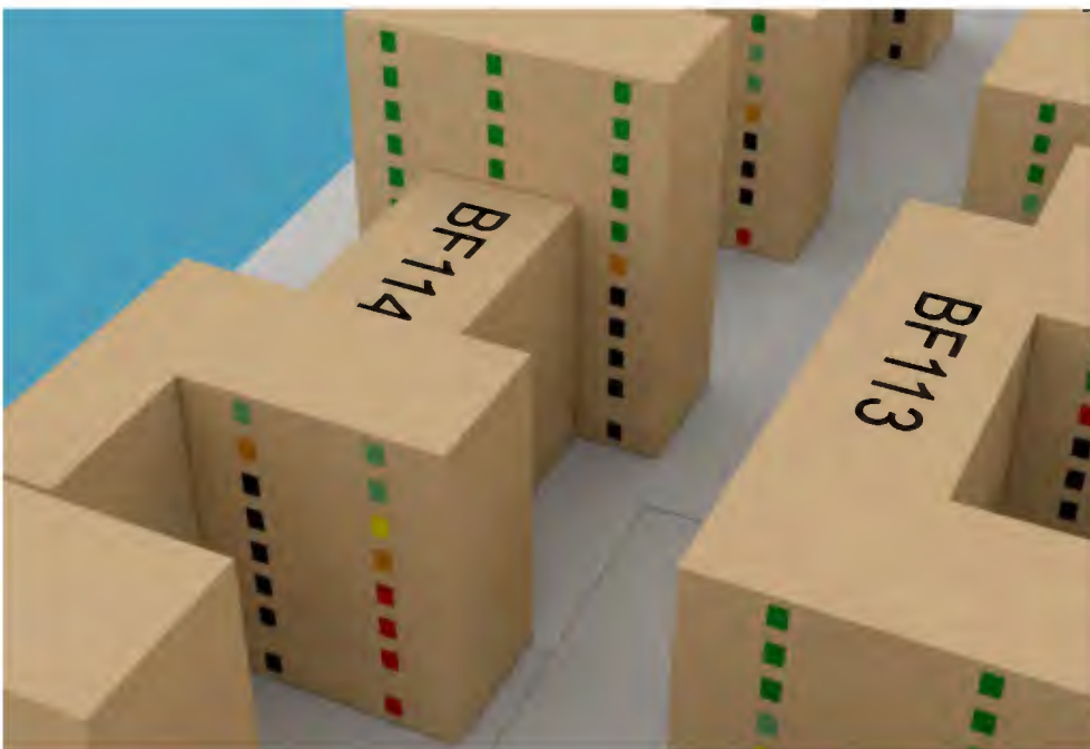
Abb. 21: Baufeld 114 - Ostfassade, abstrahiertes Modell - Fensterlaibungsinnenwert am 20.03.
