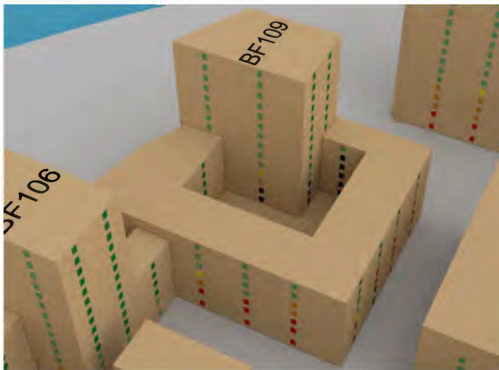
Abb. 49: Baufeld 109 - Westfassade - Fensterlaibungsinnenwert am 20.03. - Stand: 02.09.2021
