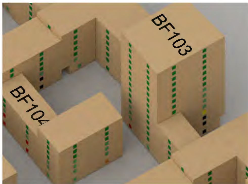
Abb. 29: Baufeld 103 - Südfassade und Ostfassade - Fensterlaibungsinnenwert am 20.03. - Stand: 02.09.2021
