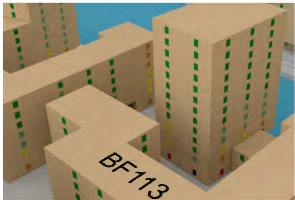
Abb. 7: Baufeld 113 - Südfassade, abstrahiertes Modell - Fensterlaibungsinnenwert am 20.03
