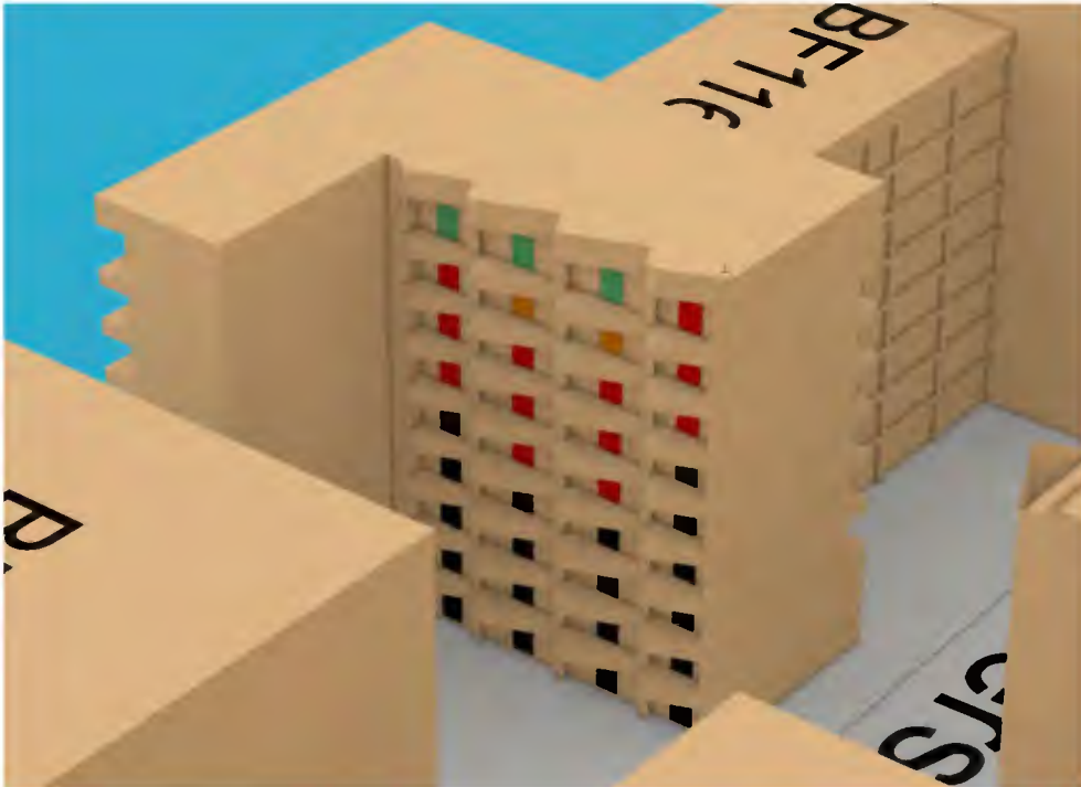
Abb. 40: Baufeld 116 - Ostfassade - Fensterlaibungsinnenwert am 20.03.
