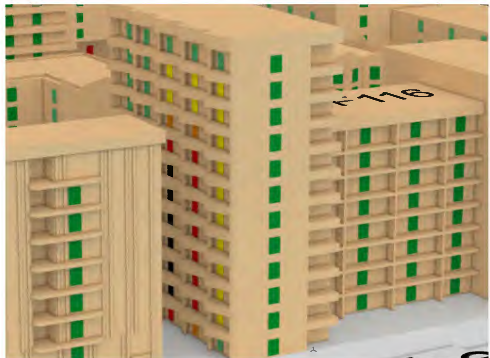
Abb. 83: Baufeld 116 - Westfassade - Fensterlaibungsinnenwert am 20.03. - Stand: 02.09.2021
