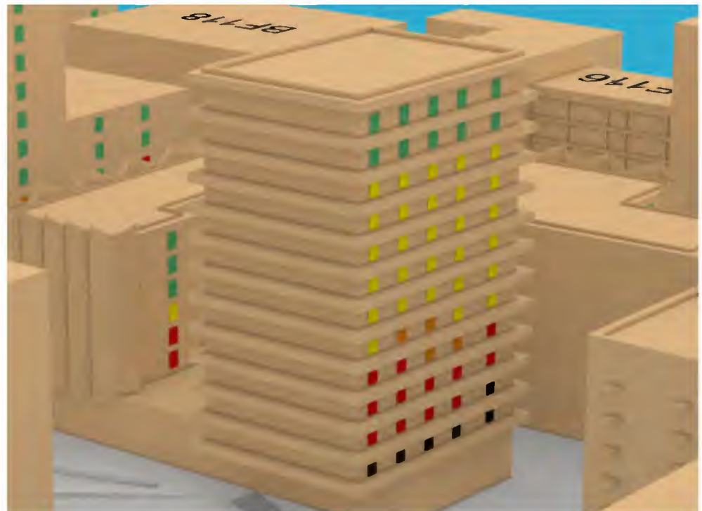
Abb. 79: Baufeld 115 - Westfassade - Fensterlaibungsinnenwert am 20.03. - Stand: 02.09.2021
