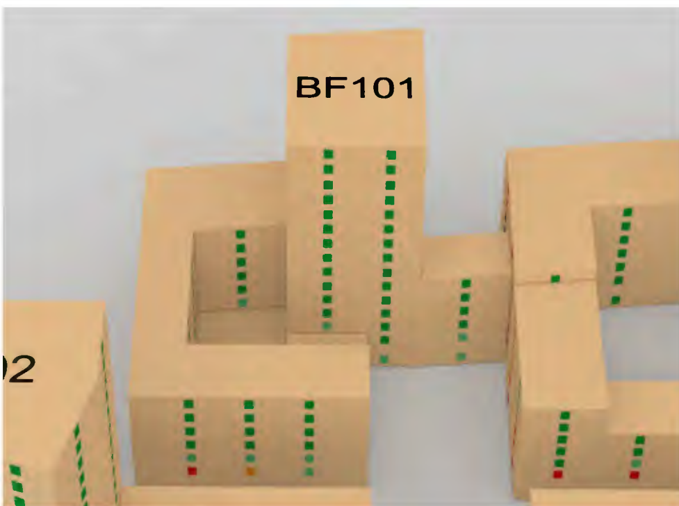
Abb. 21: Baufeld 101 - Südfassade - Fensterlaibungsinnenwert am 20.03. - Stand: 02.09.2021
