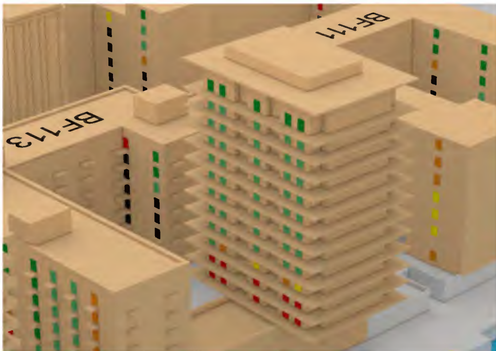
Abb. 4: Baufeld 113 - Südfassade - Fensterlaibungsinnenwert am 20.03.
