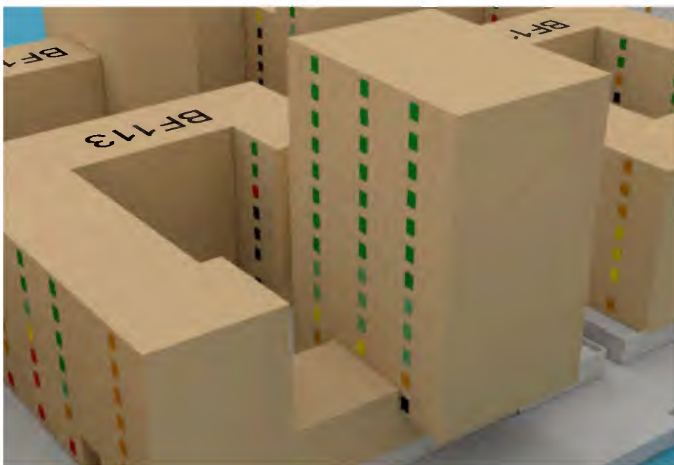
Abb. 5: Baufeld 113 - Südfassade, abstrahiertes Modell - Fensterlaibungsinnenwert am 20.03.
