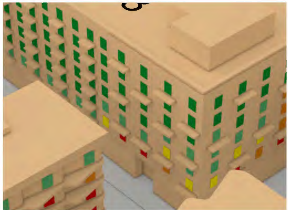
Abb. 67: Baufeld 113 - Südfassade - Fensterlaibungsinnenwert am 20.03. - Stand: 02.09.2021
