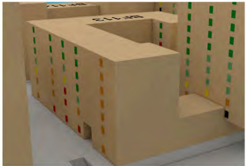
Abb. 3: Baufeld 113 - Ostfassade, abstrahiertes Modell - Fensterlaibungsinnenwert am 20.03
