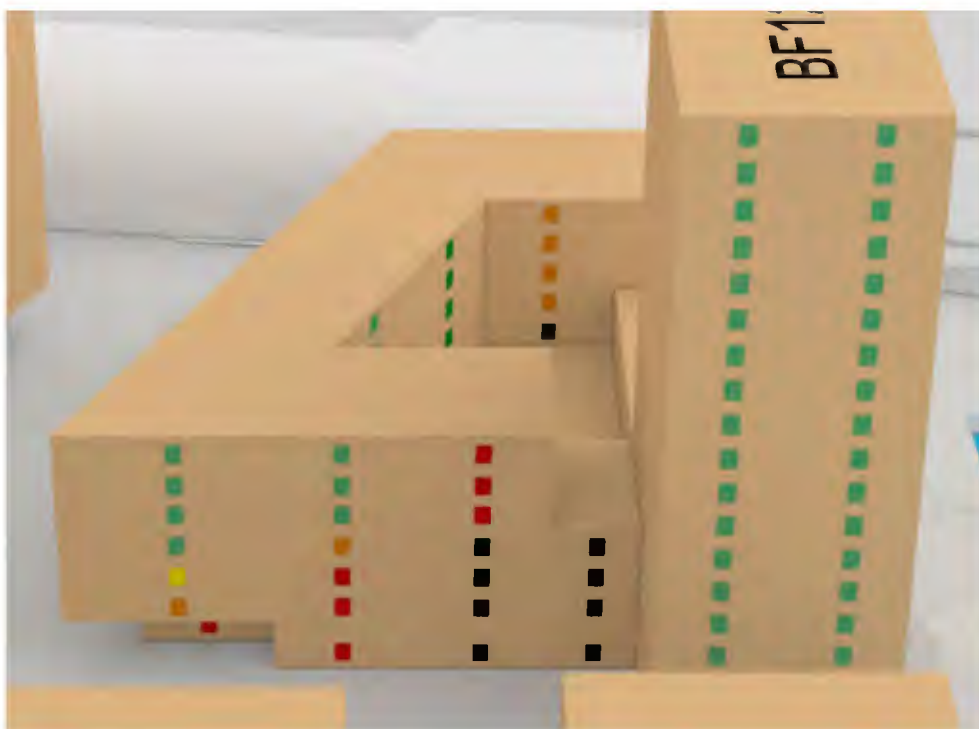
Abb. 105: Baufeld 121 - Westfassade - Fensterlaibungsinnenwert am 20.03. - Stand: 02.09.2021
