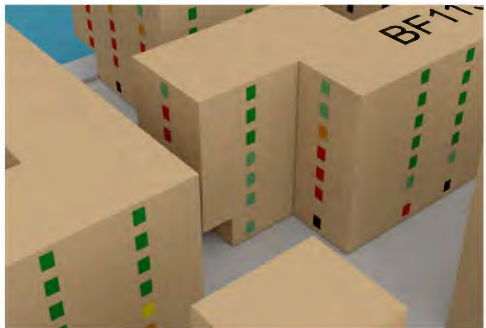
Abb. 11: Baufeld 113 - Südfassade, abstrahiertes Modell - Fensterlaibungsinnenwert am 20.03
