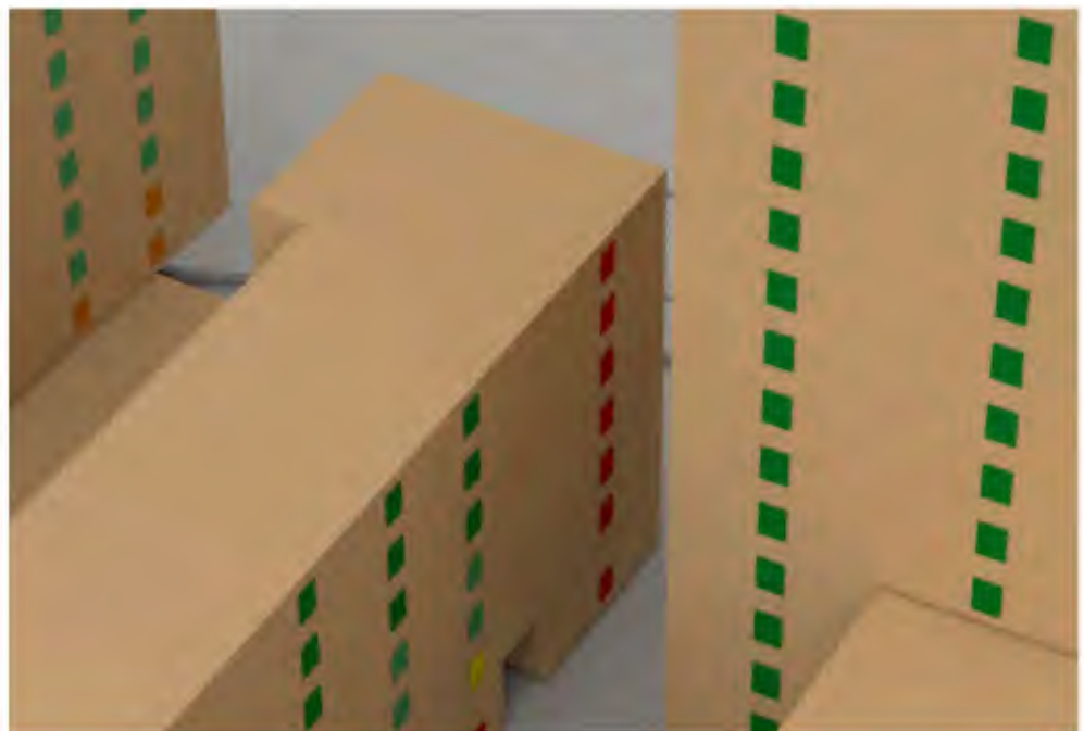
Abb. 31: Baufeld 115 - Ostfassade, abstrahiertes Modell - Fensterlaibungsinnenwert am 20.03
