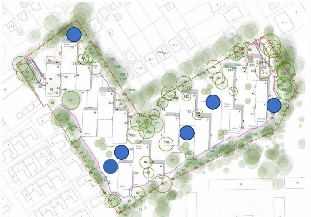
Abbildung 10: Größenordnung und ungefähre Flächenbedarfe der Eisspeicher mit einem Durchmesser von ca. 14 m unter Berücksichtigung des Baumbestandes und der Tiefgaragenposition (Quelle: KBNK Architekten GmbH, eigene Darstellung)
