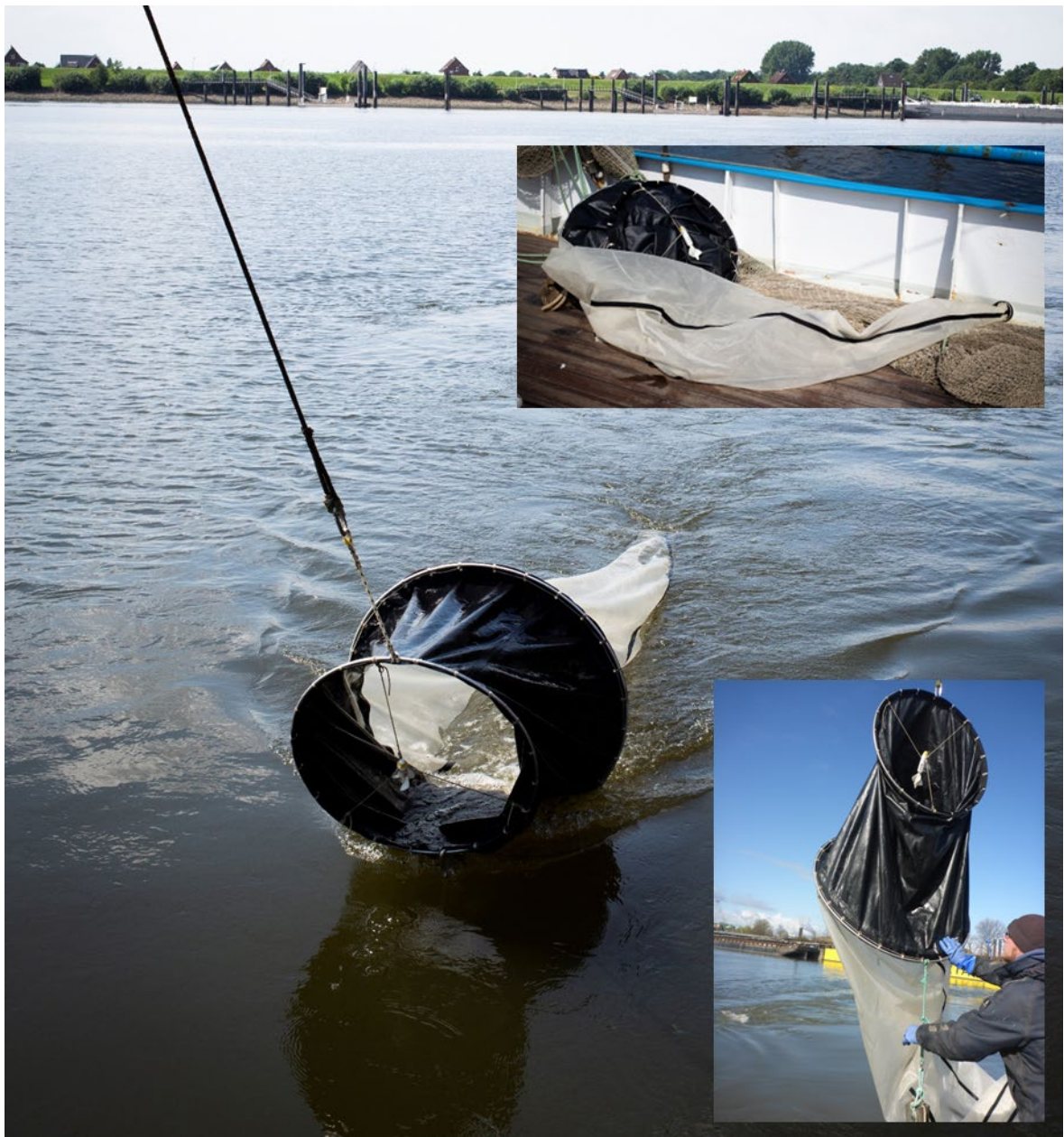
Abb. 2: Ringnetz zur Beprobung von Fischlarven (Fotos: [REDACTED], Fabelzucker & BioConsult).
