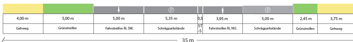
Abbildung 9: Abmessung des Straßenquerschnitts Alsterufer (Nr. 1), Richtung Norden
