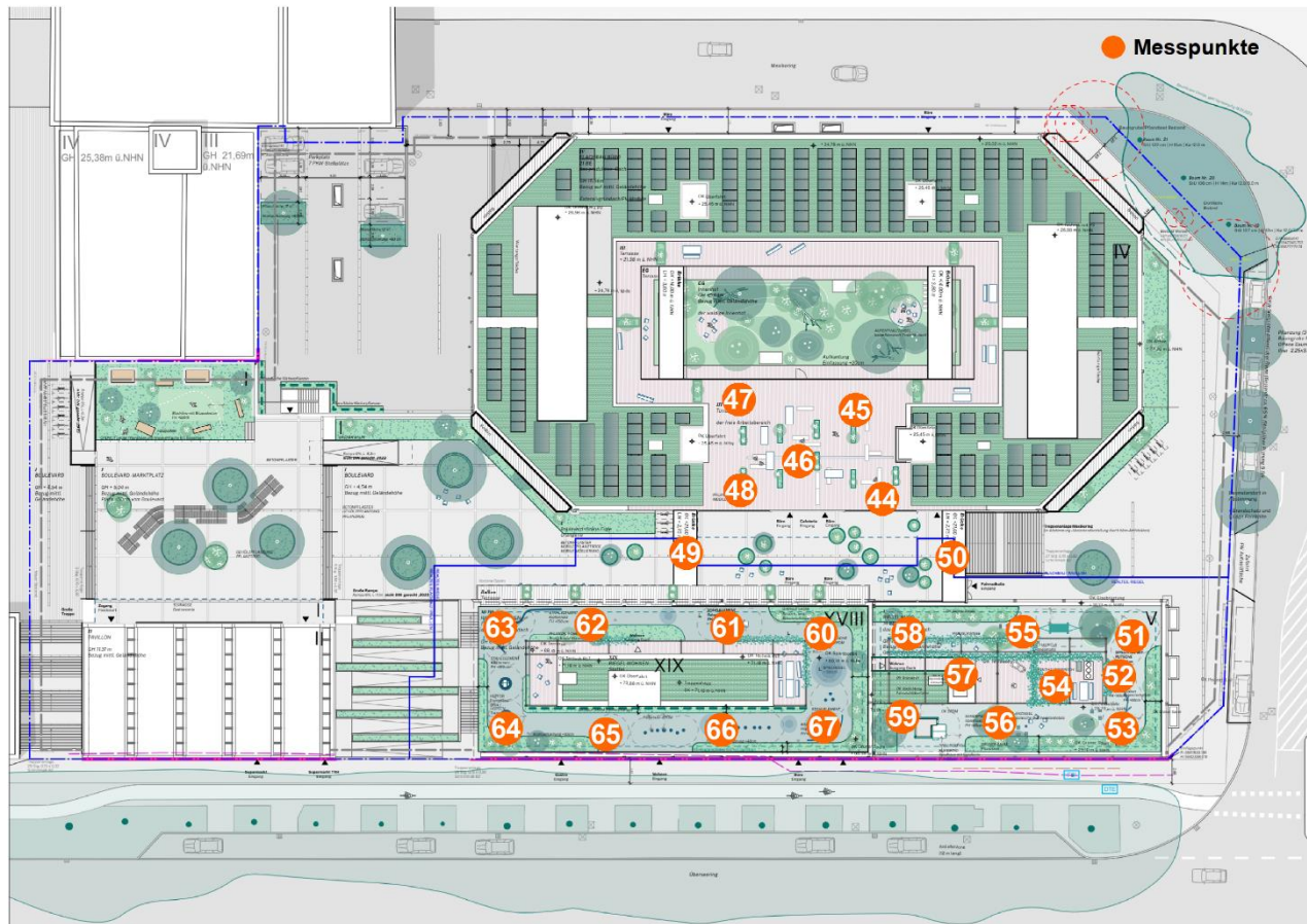
Abb. 3.4: Bezeichnungen und Positionen der Messstellen auf den Dachterrassen des Bauvorhabens Überseering 17 in Hamburg (Plangrundlage via blmr, 2023) Dachterrassen
