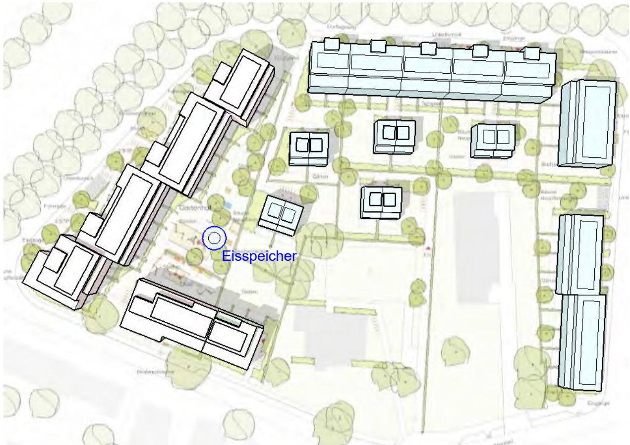
Abbildung 20: exemplarische Darstellung Position Eisspeicher (Durchmesser 8 m äußerer Kreis)
