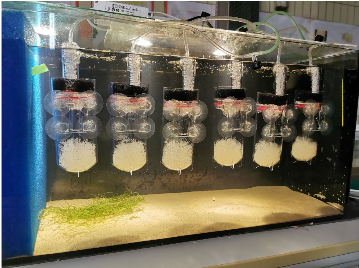
Abb. 5: Belüftete Inkubatoren zur Erbrütung von Stinteiern, Februar 2022.
