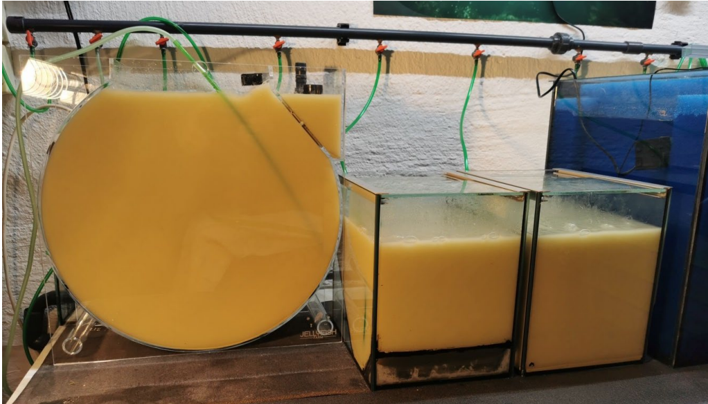
Abb. 1: Vorversuche zur Trübungshaltung/Sedimentation mit verschiedenen Setups. Von links nach rechts: Kreiselbecken, Schrägbodenbecken (doppelt), Schrägbodenbecken (einseitig).
