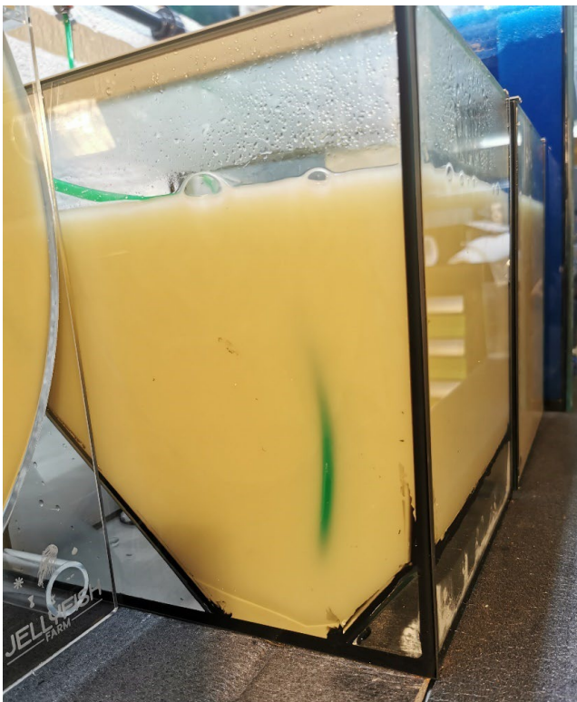
Abb. 2: Seitenansicht eines Versuchsbeckens mit doppeltem Schrägboden.
