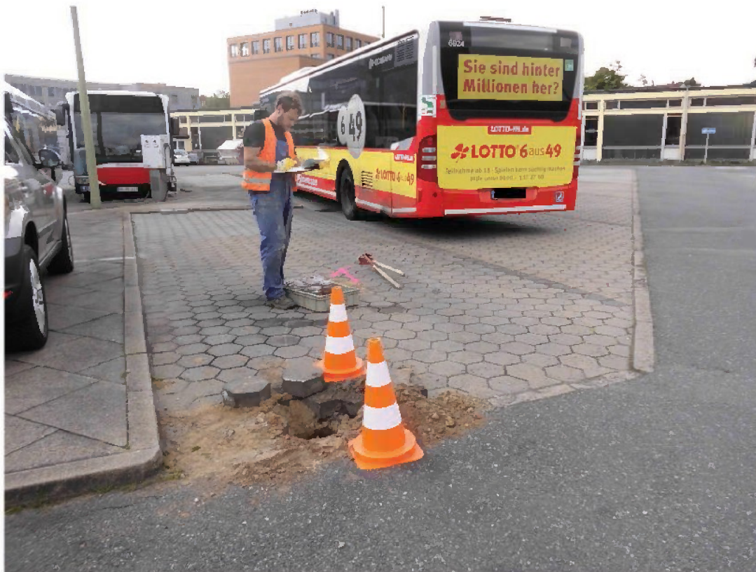
RKS 1 im Nordostteil des Busbetriebshofes, Abbruch wegen massiven Hindernisses
