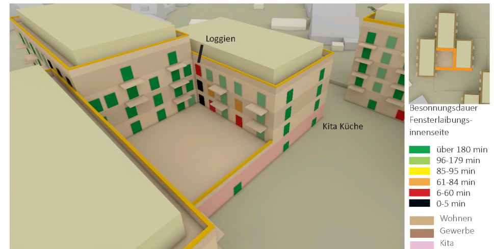
Haus 1 - Süd- und Westninnhoffassade - Fensterlaibungsinnenwerte am 20.03.
