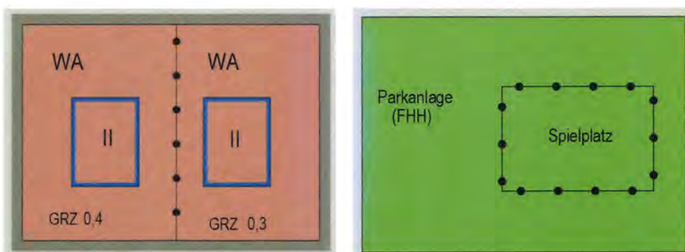
Abbildung 6: Darstellung von verschiedenen Nutzungsabgrenzungen. Die Flächen werden einzeln erfasst und die Abgrenzungslinie als Linienobjekt ergänzt. Die Stützpunkte der Abgrenzungslinie müssen identisch mit den Stützpunkten der Flächenschlussfläche sein.
