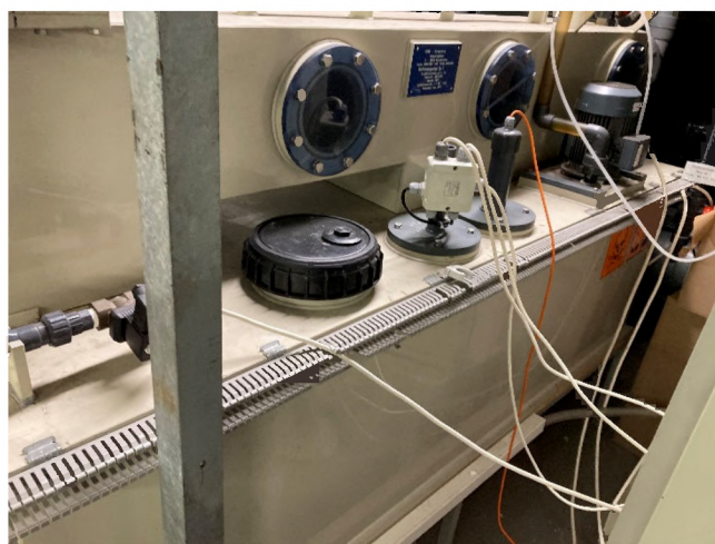
Abbildung 135: Abluftreinigungsanlage
