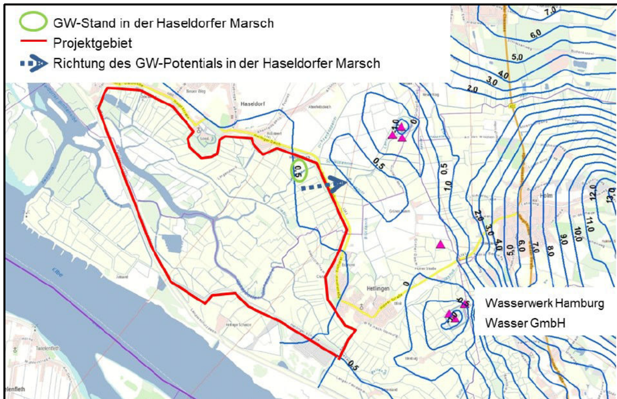
Abb. 7 Grundwassergleichenplan des oberen Grundwasserleiters aus 1988 (vgl. [U3] und [U5])
