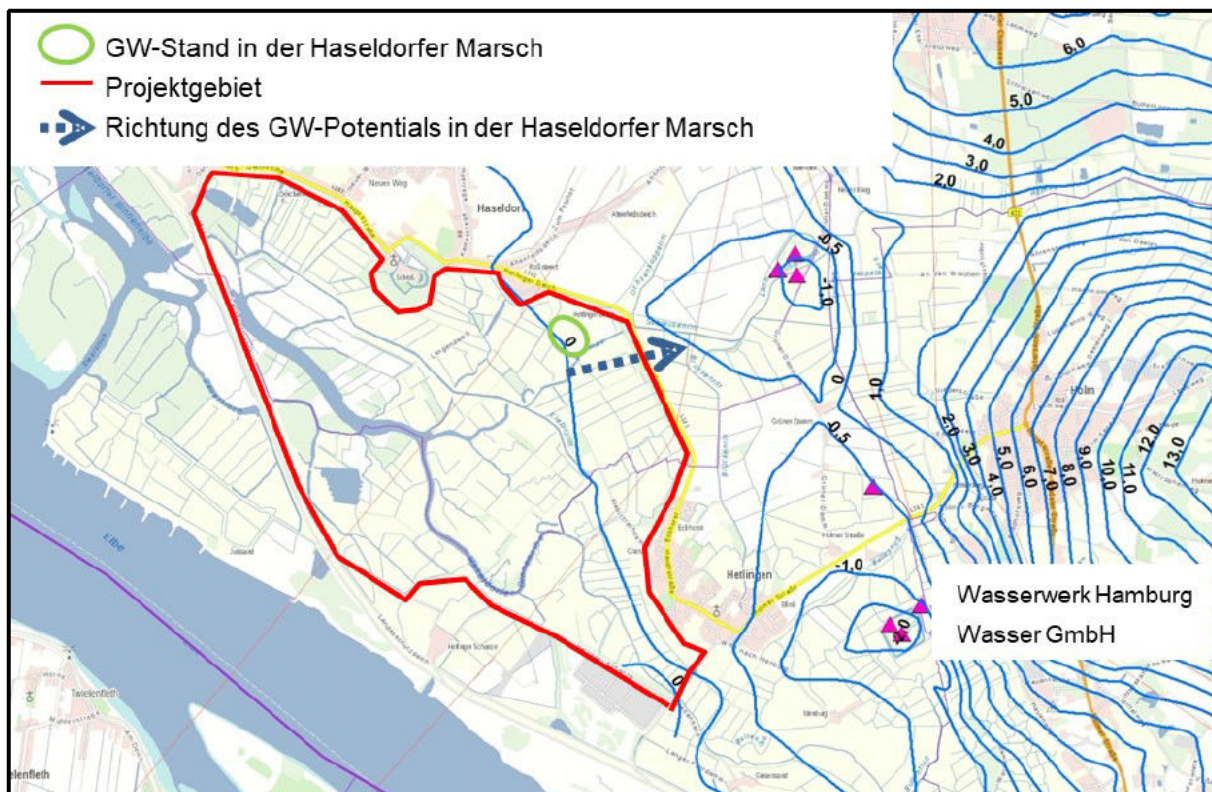
Abb. 9 Grundwassergleichenplan des oberen Grundwasserleiters aus 1994 (vgl. [U3] und [U5])
