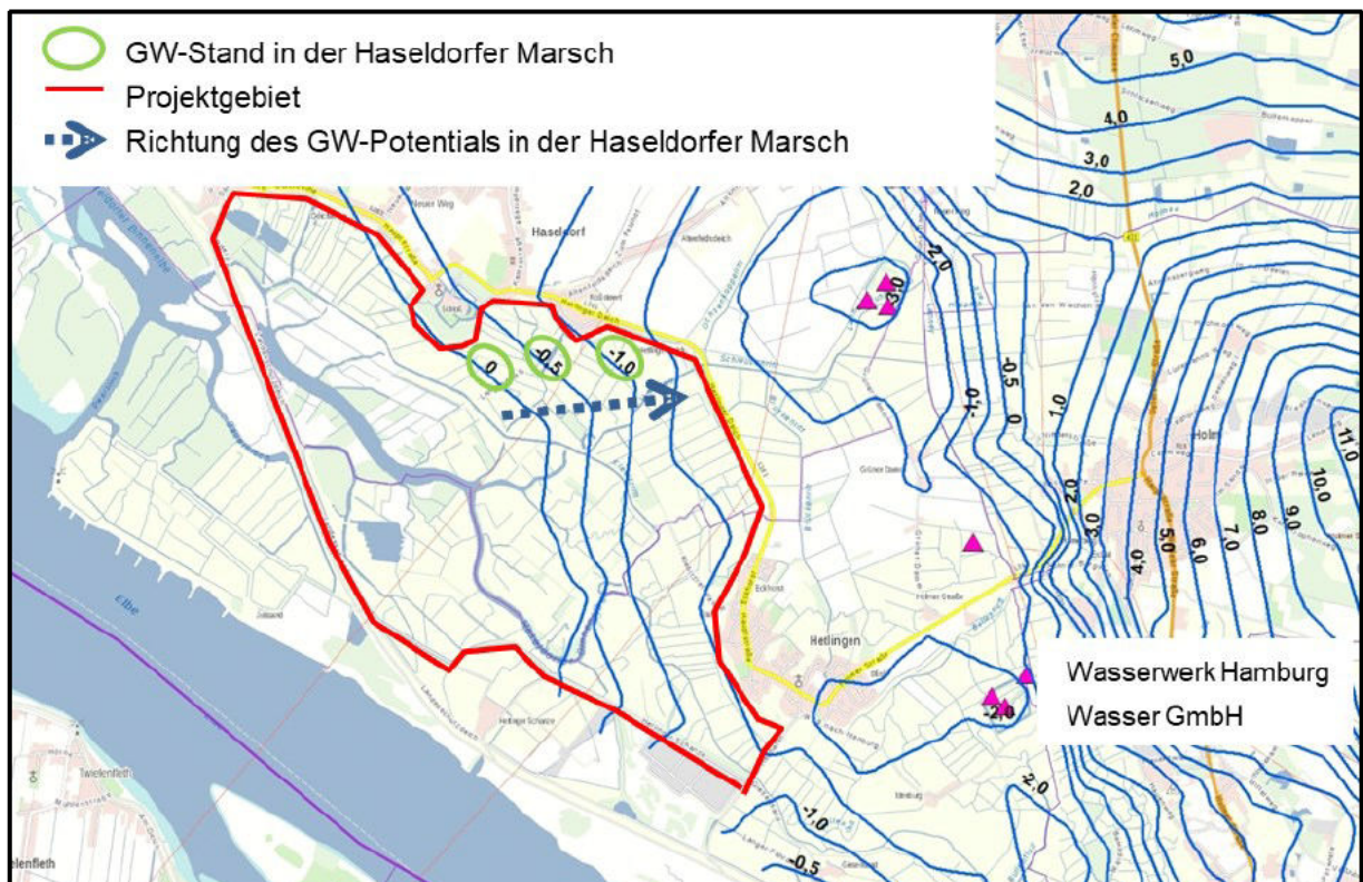
Abb. 8 Grundwassergleichenplan des oberen Grundwasserleiters aus 1989 (vgl. [U3] und [U5])
