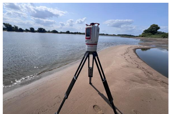
Abbildung 3: Laserscanner Riegl VZ400i im Einsatz.
