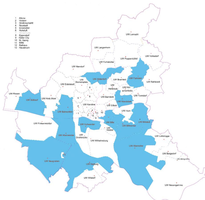
Abbildung 4.9: Engpässe in Blau im Mittelspannungsnetz 2029 bis 2033, wenn keine Netzoptimierung durchgeführt werden würde (Stromnetz Hamburg GmbH 2024)
