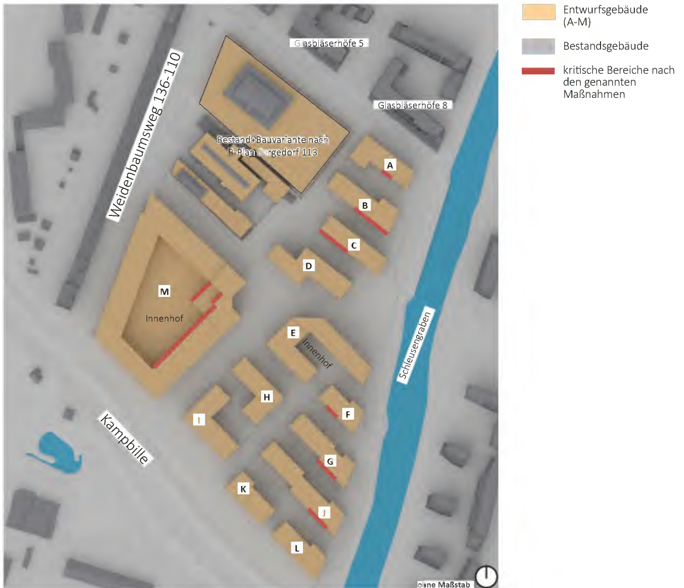
Abb. 64: Verortung der Fassadenabschnitte mit kritischen Bereichen nach den Maßnahmen
