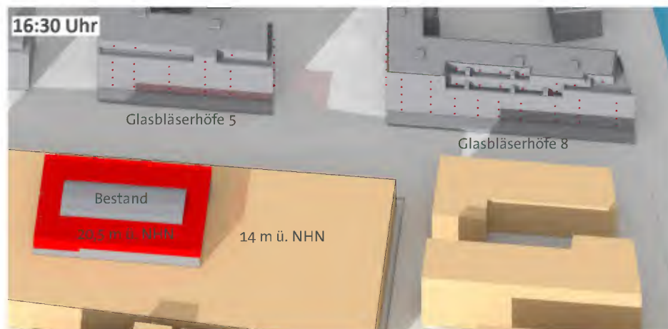
Abb. 2: Gewerbegebiet mit 14 m ü. NHN, Bestandsgebäude mit 20,5 m ü. NHN - Südfassade Glasbläserhöfe 5 und 8 am 20.03. - 16:30 Uhr
