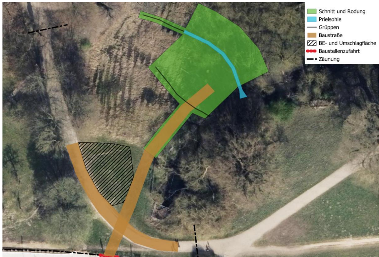
Abbildung 2 – Ausschnitt Lageplan - Baustellenübersicht Schnitt und Rodungsarbeiten.
