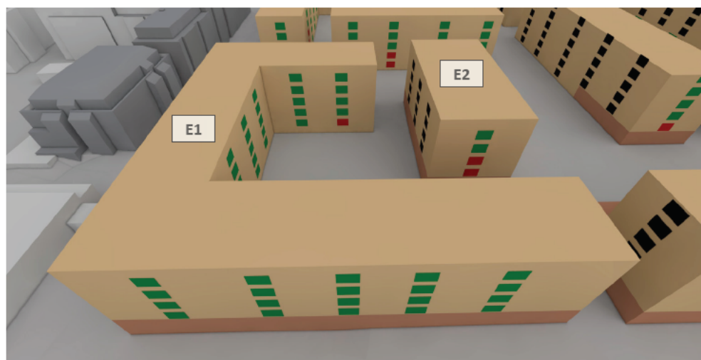
Abb. 61: Gebäude E1 und E2 - Westfassade - Besonnung Fensterlaibungsinnenseite am 20.03.
