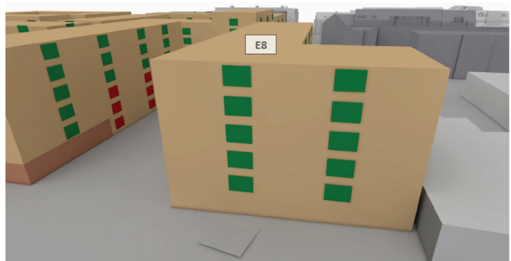
Abb. 96: Gebäude E8 - Südfassade - Besonnung Fensterlaibungsinneseite am 20.03.
