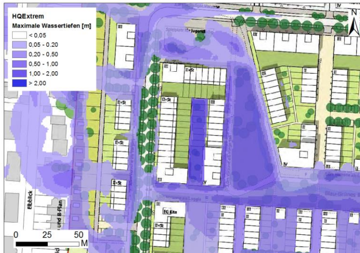
Abbildung 5-6: Max. Wassertiefen (HQ Extrem ) an der Parkanlage Blau-Grünes Band
