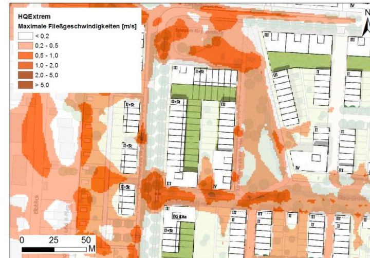
Abbildung 5-7: Max. Fließgeschwindigkeiten (HQ Extrem ) an der Parkanlage Blau-Grünes Band
