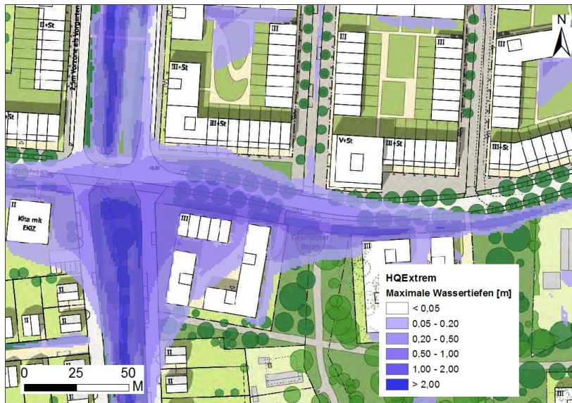
Abbildung 5-8: Max. Wassertiefen (H Q Extrem) östlich der Überquerung Rethenbek
