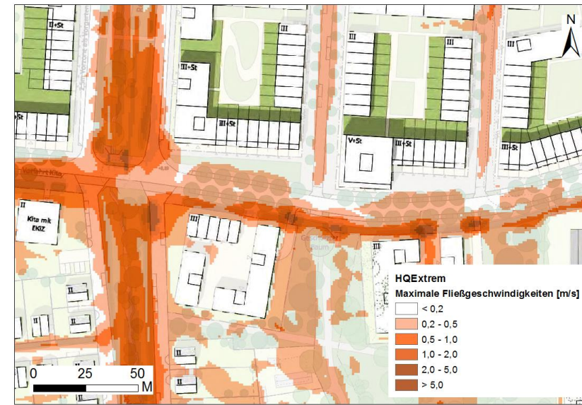
Abbildung 5-9: Max. Fließgeschwindigkeiten (H Q Extrem) östlich der Überquerung Rethenbek
