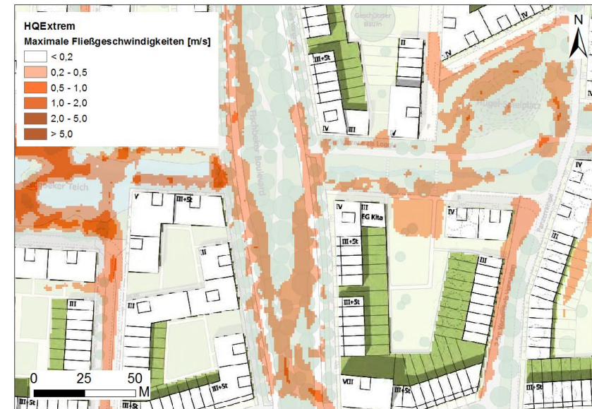
Abbildung 5-11: Max. Fließgeschwindigkeiten (HQ Extrem ) am Fischbeker Boulevard
