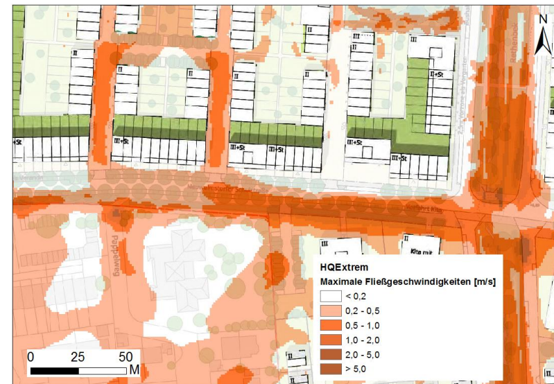
Abbildung 5-5: Max. Fließgeschwindigkeiten (H QExtrem ) an der Neuwulmstorfer Schulstraße
