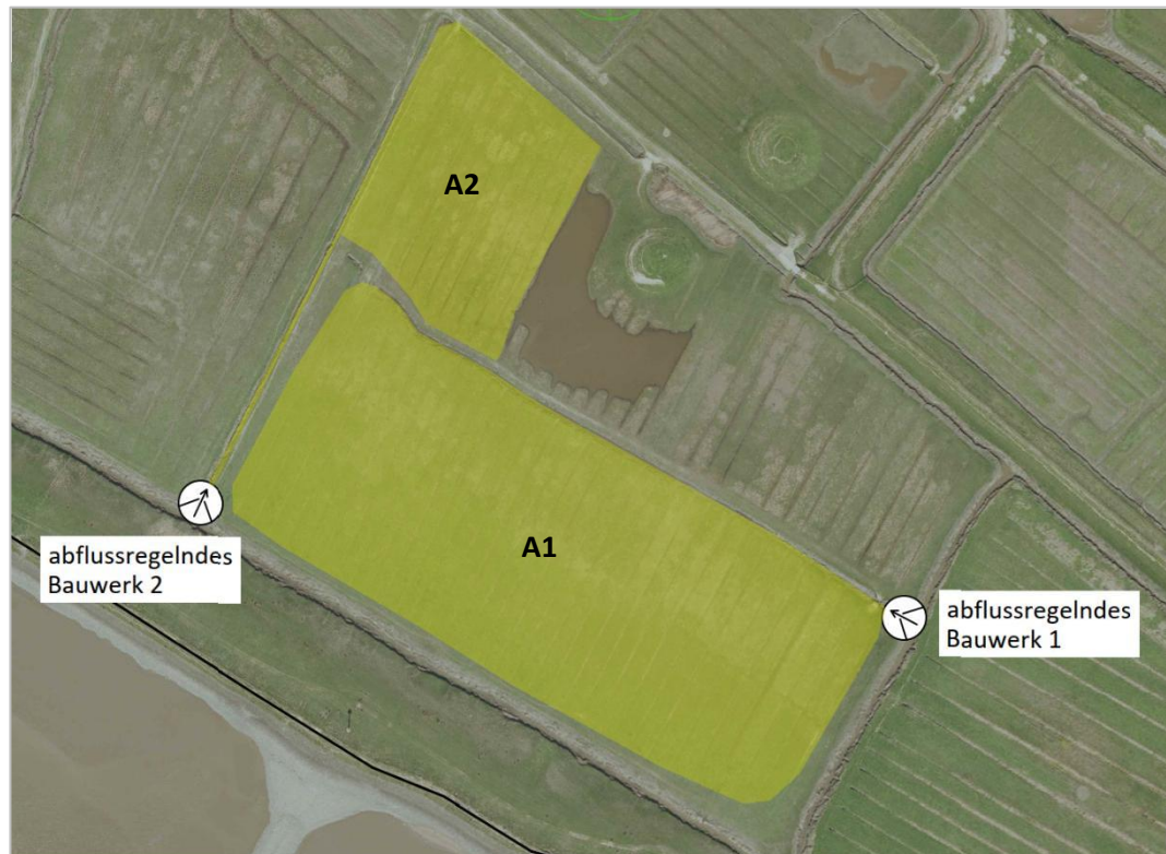
Abb. 3-9: Beeinflusste Flächen bei abflussregelndem Bauwerk
