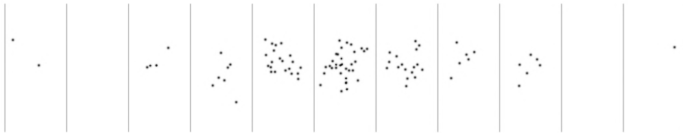
Abb. 4: Auftrefforte der Photonen in der Detektorebene bei einem Doppelspaltexperiment. Die vertikalen Linien zeigen die Stellen an, an denen aufgrund destruktiver Interferenz keine Photonen zu erwarten sind.
