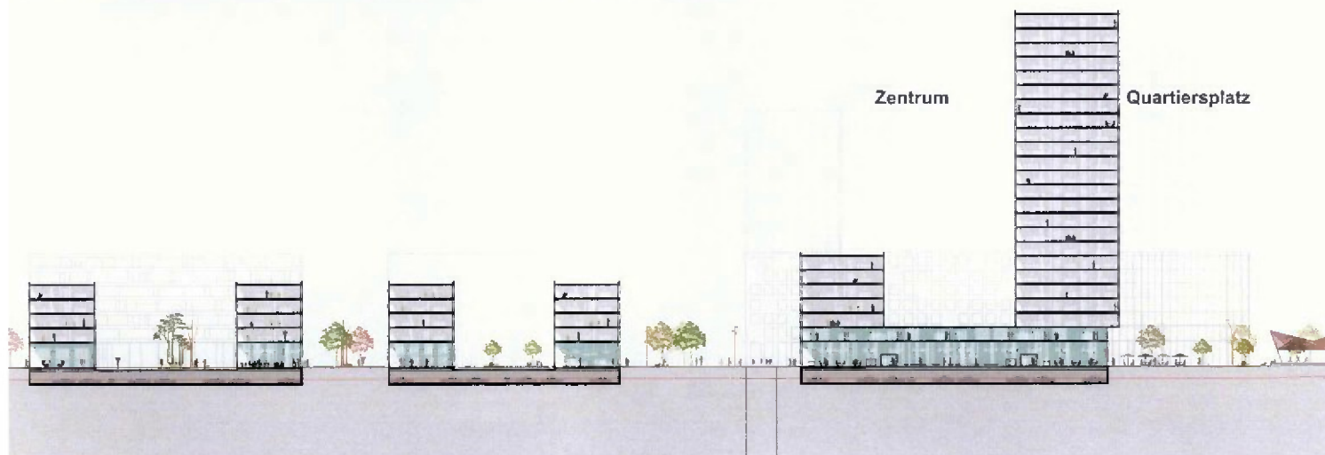
Lupe Teil 3: Längsschnitt Maßstab 1:1000 (rote Linie: bestehende Topographie)
