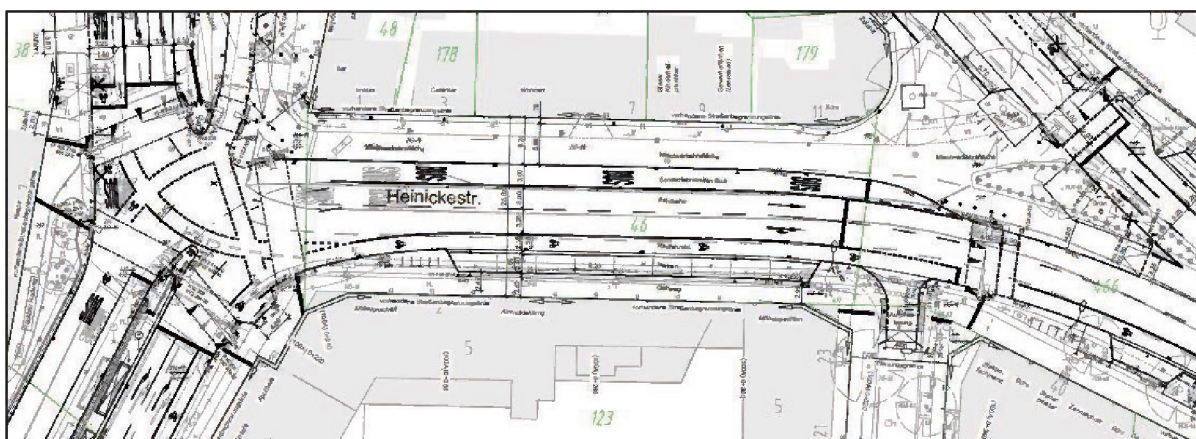
Abbildung 9: Bereich Heinickestraße; Mischverkehrsfläche
