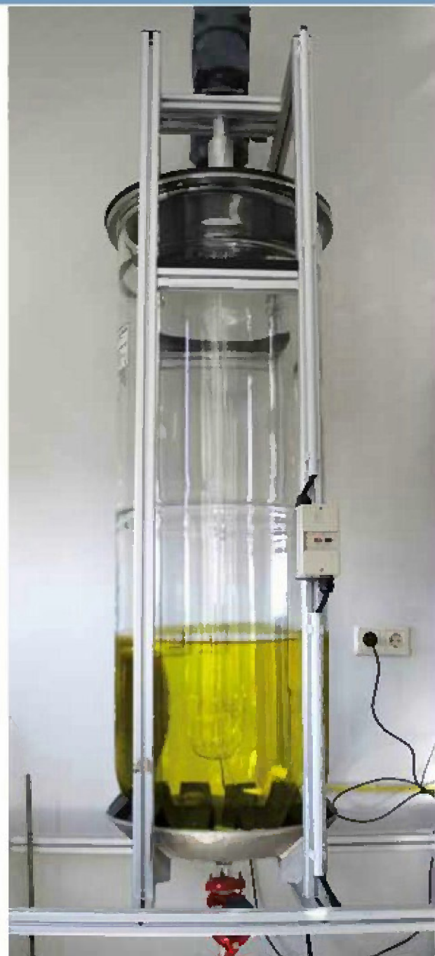
150 L-Glasbehälter plus Glasrührer zum Mischen von Flüssigkeiten
