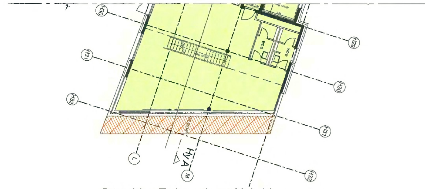
Grundriss Erdgeschoss Hybrid Fläche unterhalb der Auskragung schallabsorbierend verkleidet
