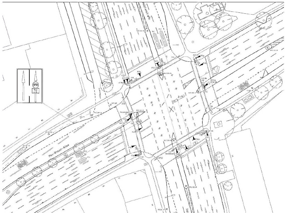
Abbildung 34: Signallageplan Holstenstraße/Max-Brauer-Allee – Bestand (10/131-04-05/02)
