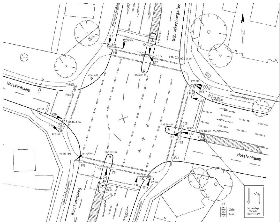
Abbildung 45: Signallageplan Bornkampsweg/Holstenkamp – Bestand (03/1148-04-04/01)
