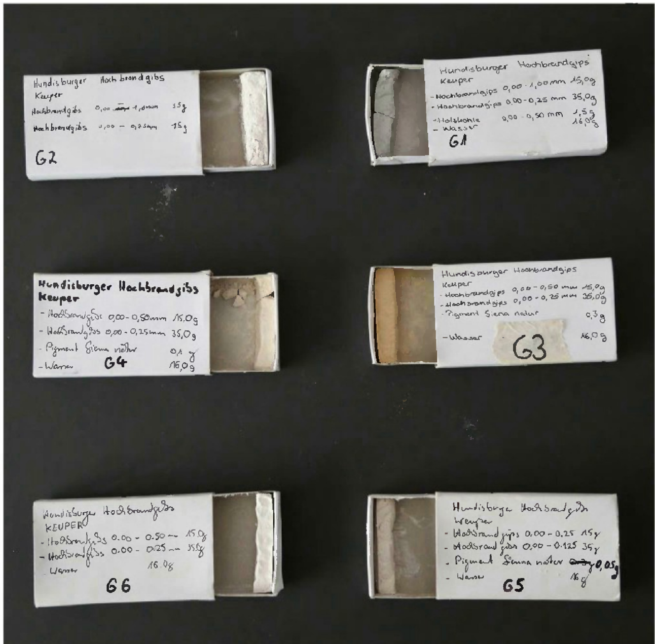
Abb. 7: Muster für Mörtelproben am Hufnerhaus; Entstanden 2016 im Rahmen einer Projektwoche der Stader Jugendbauhütte.
