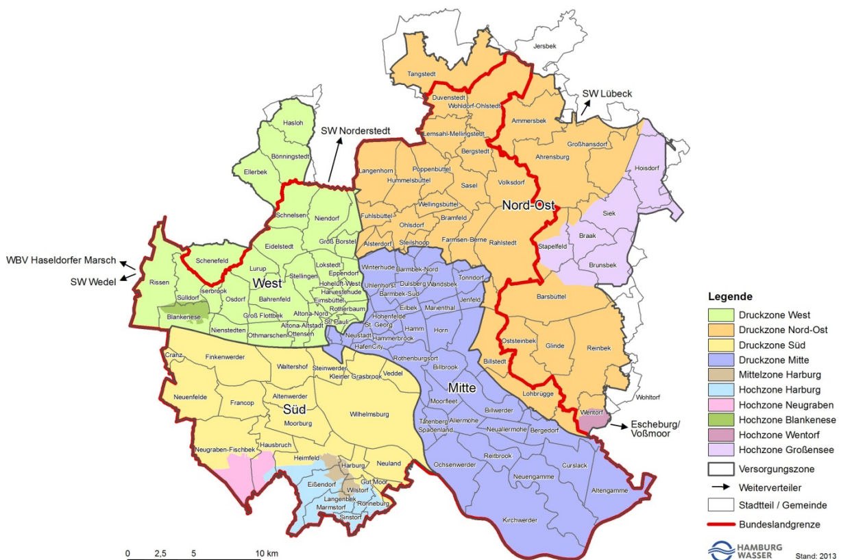
Abbildung 1: Struktur des Versorgungsgebiets von HAMBURG WASSER
