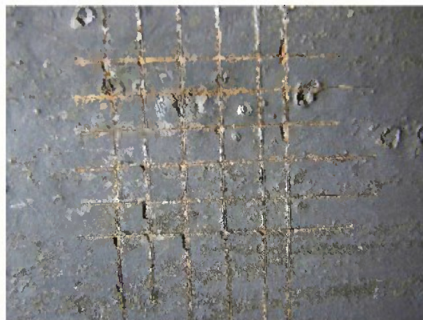
Gitterschnitt 1 auf der Vorderseite GK2, nach Abzug, geringe Enthftung der Beschichtung, ISO Kennwert GT 1-2
