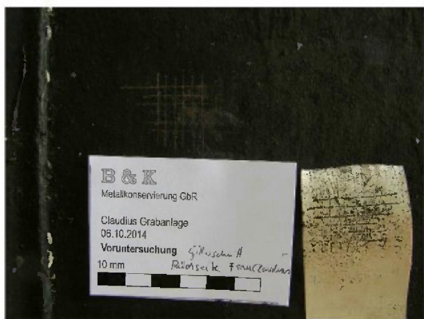
Gitterschnitt 2 auf der Rückseite GK1, nach Abzug, geringe Enthftung der Beschichtung, ISO Kennwert GT2-3
