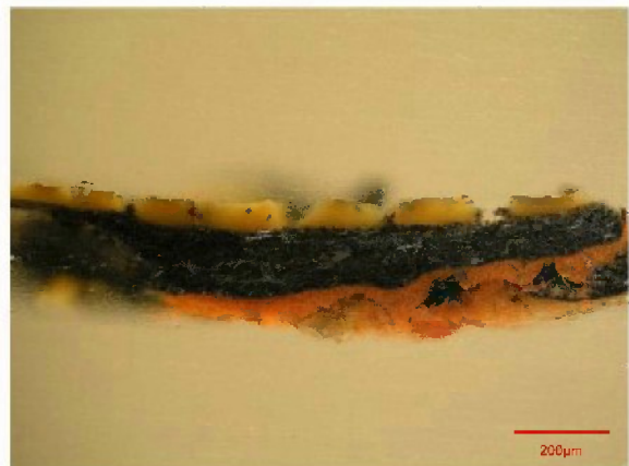
Probe 2: mikroskopische Aufnahme des Anschliffes im Hellfeld.
