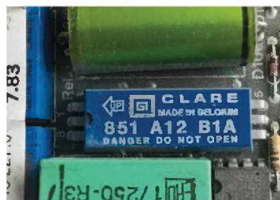
Abb. 2.7.9: Quecksilberhaltiges Bauteil auf einer Leiterplatte
