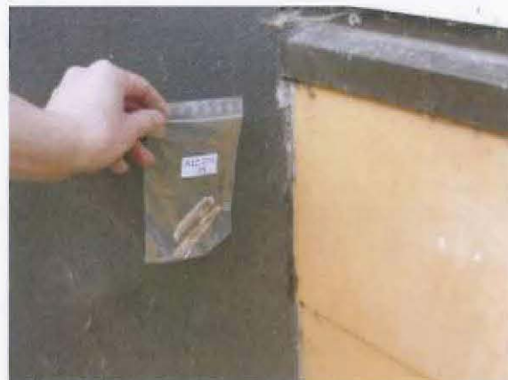
Abb. 25: Probe A12.074-29a von der Fugenmasse in der Mischprobe Nr. -33a
