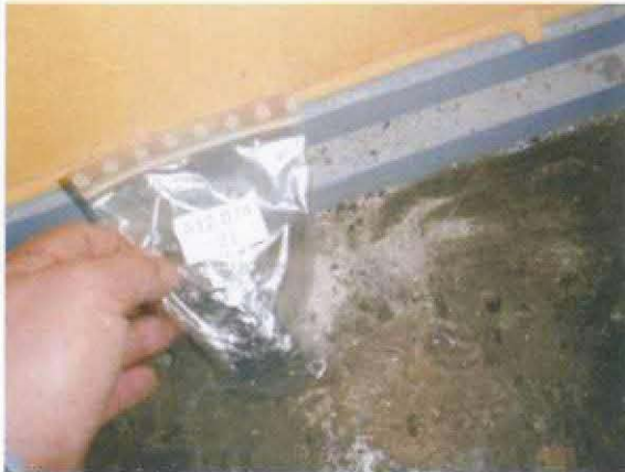
Abb. 10: Probe A12.074-21 des Bodenaufbaus, Estrich und Trennlage
