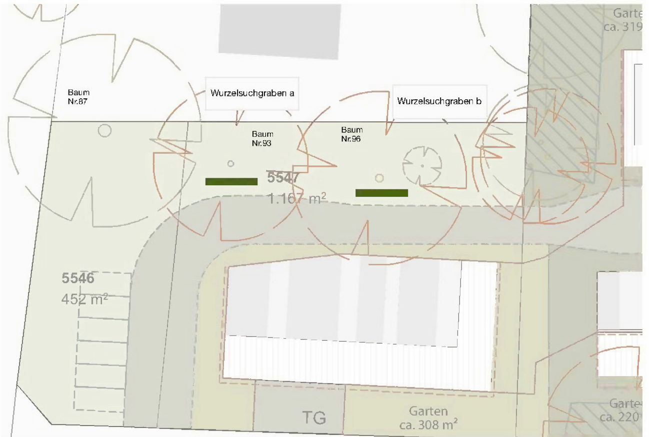
Abb.1: Lage der Wurzelsuchgräben (a) und (b)
