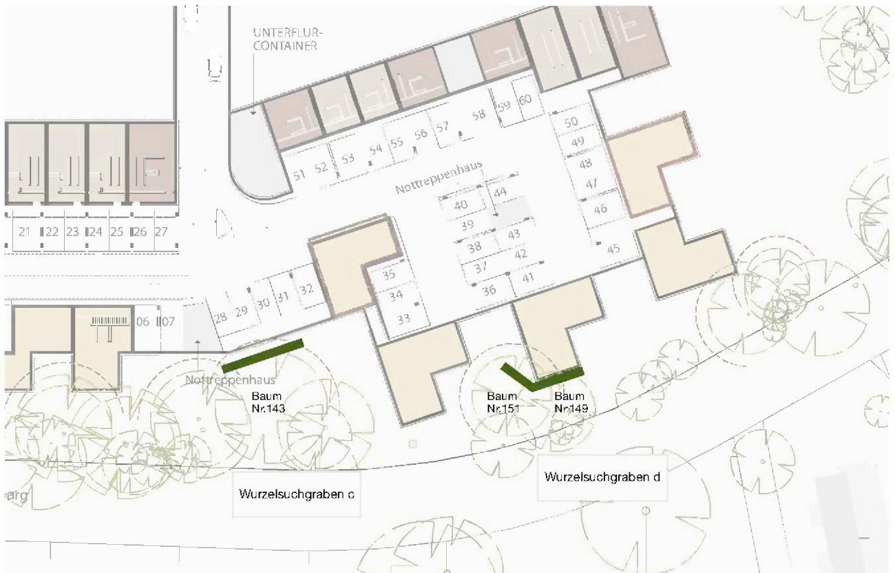
Abb.2: Lage der Wurzelsuchgräben (c) und (d)
