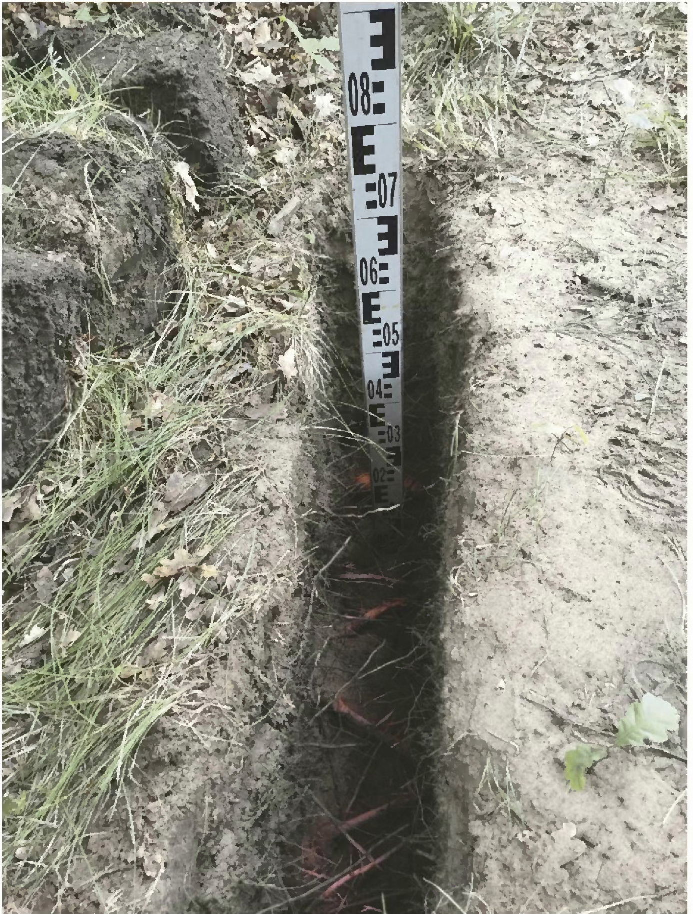
Abb.19: Suchgraben (d) - Baum Nr. 149 und Nr.151, angelegter Wurzelsuchgraben in einer Tiefe von ca. 0.7m
