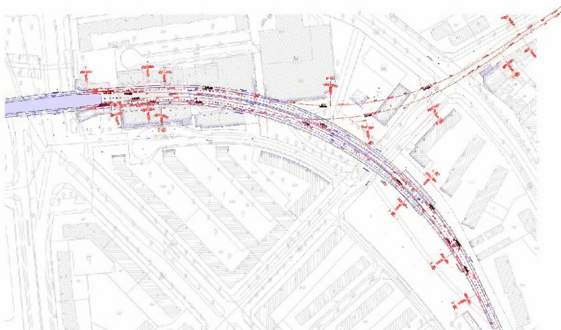
Abbildung 23: Alternativausfädelung 3 (Einfädelung auf freier Strecke)
