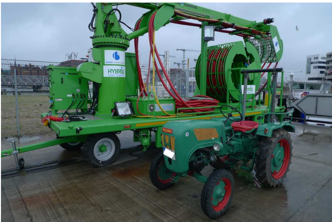
Abbildung 27: Kabelverbindung für den Anschluss der Hybrid Barge und Zugmaschine am 19.6.2015
