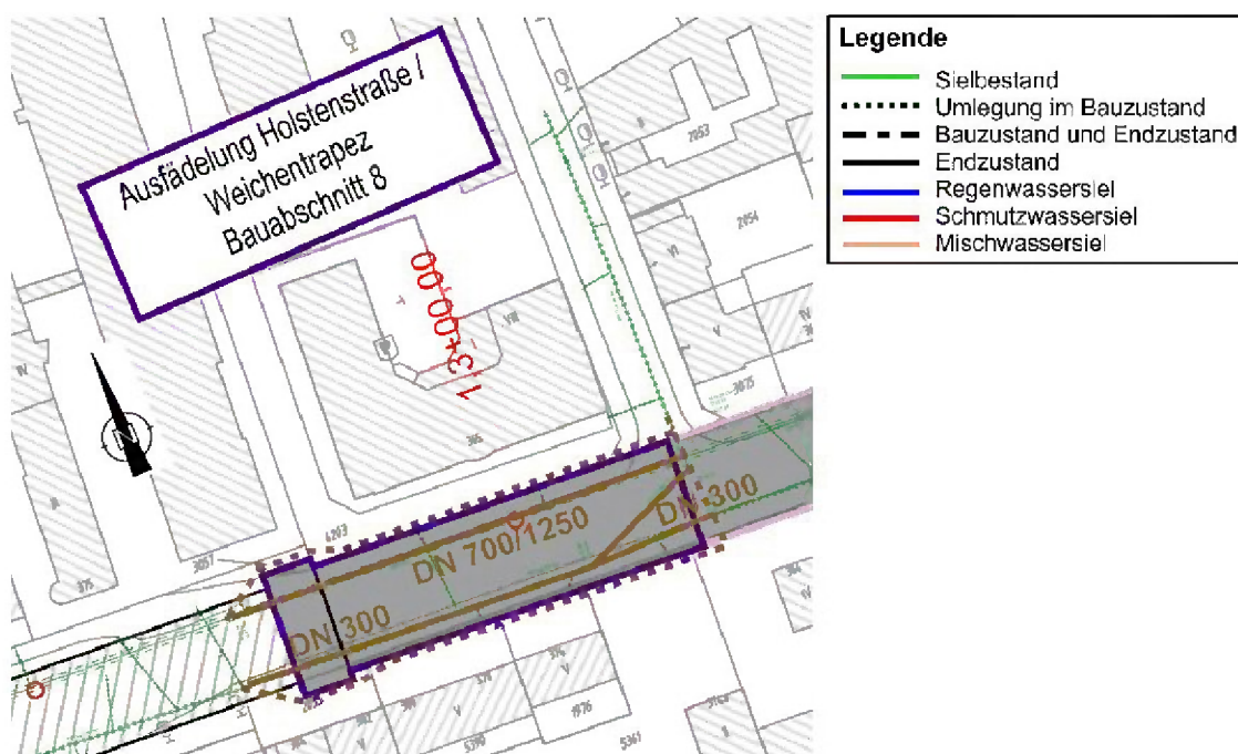
Abbildung 46: Sielplan Baubereich Weichentrapez, Bauabschnitte 8 (Stand 04.2019)
