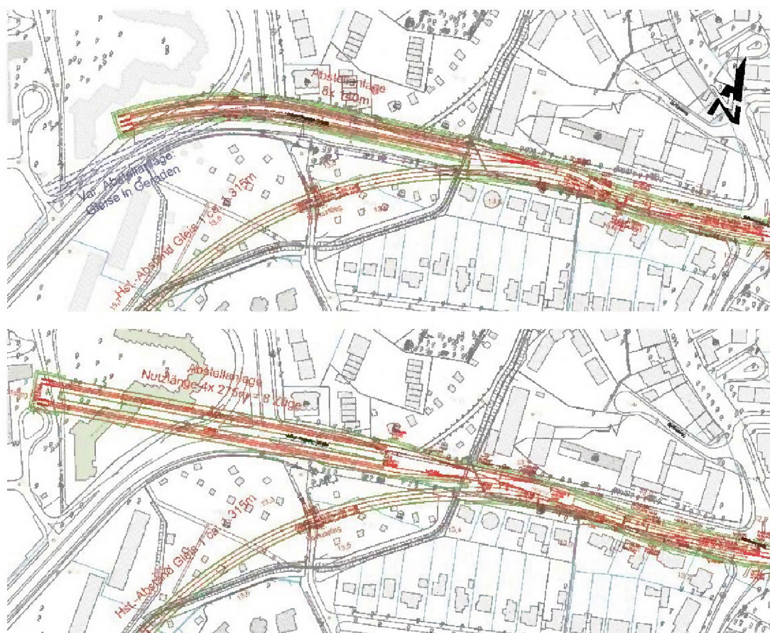
Abbildung 96: Abstellanlage westlich der Haltestelle Behrmannplatz I in geschlossener Bauweise (oben) und in offener Bauweise mit teilweise gebogenen und alternativ mit geraden Abstellgleisen (unten)
