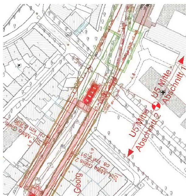
Abbildung 53: Variante St. Georg IV - Bauweise mit 2 Bahnhofsschilden in Abschnitt 1
