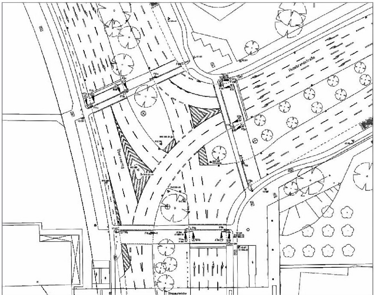
Bild 5.2.7 - 3 Signallageplanausschnitt LSA 630
