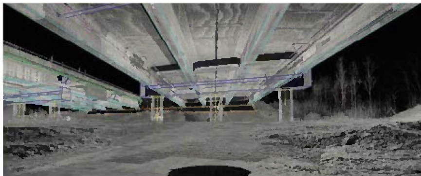
Visualisierung der Scanaufnahme und CAD der Bauelemente
