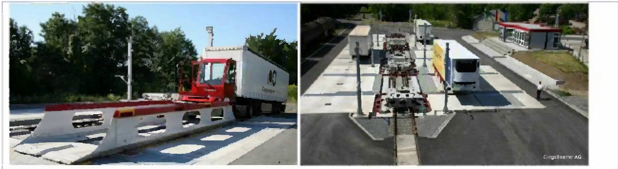
Abbildung 81 CargoBeamer Waggonaufsatz und vollautomatisierte Verladung in der Testanlage in Leipzig
