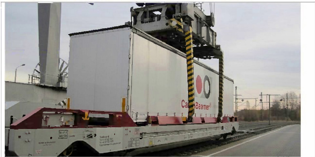
Abbildung 82 Konventionelle Kranverladung des CargoBeamer Waggonaufsatzes
