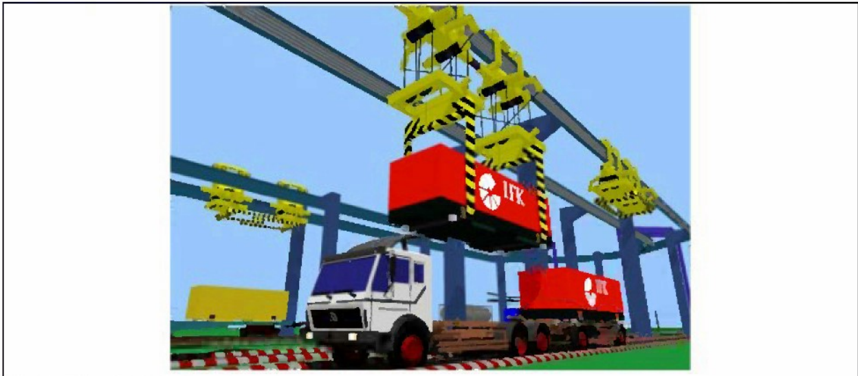
Abbildung 73 Umschlag eines Wechselbehälters mit dem EHB-System Concar
