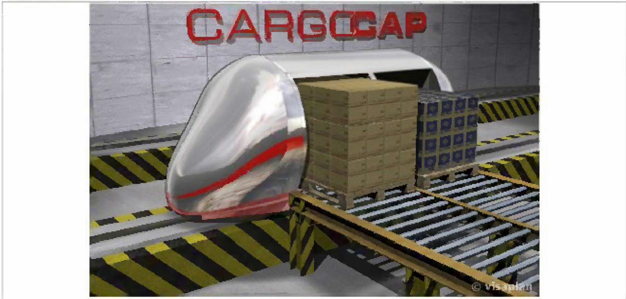
Abbildung 78 Cargocap bei der Be- und Entladung
