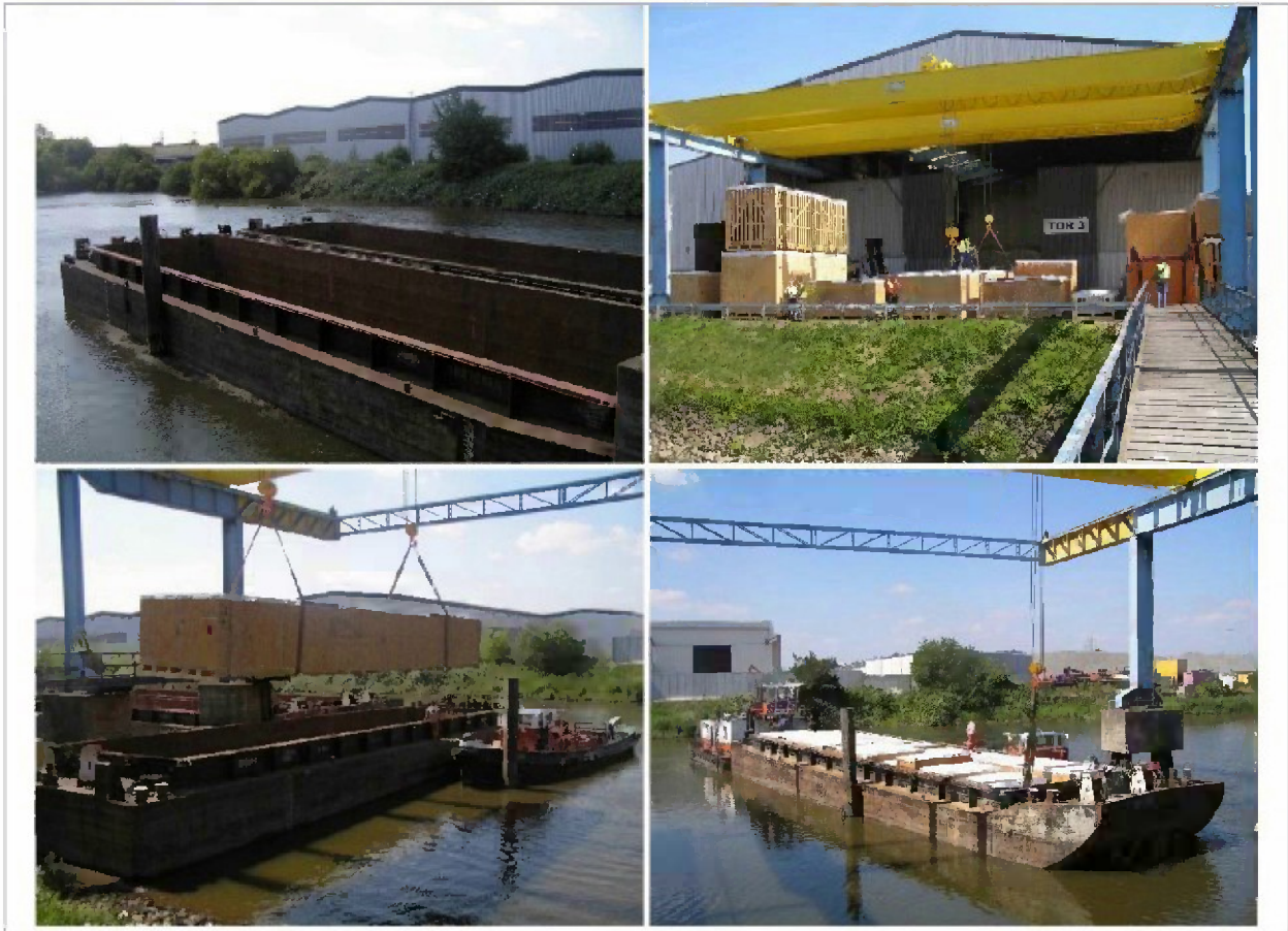
Abbildung 25 Binnenschiffsverladung bei akf mit Portalkran
